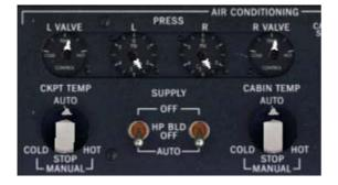
Indicateurs L/R de position de la valve de contrôle de température :
