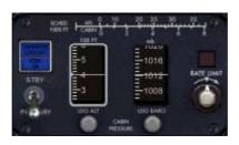
Bouton rotatif « LDG ALT » : Utilisé pour régler l'altitude de l'aéroport de destination dans la fenêtre LDG ALT. L'échelle est graduée par incrément de 100 ft. FLOW Lt: (appuyer pour tester)
